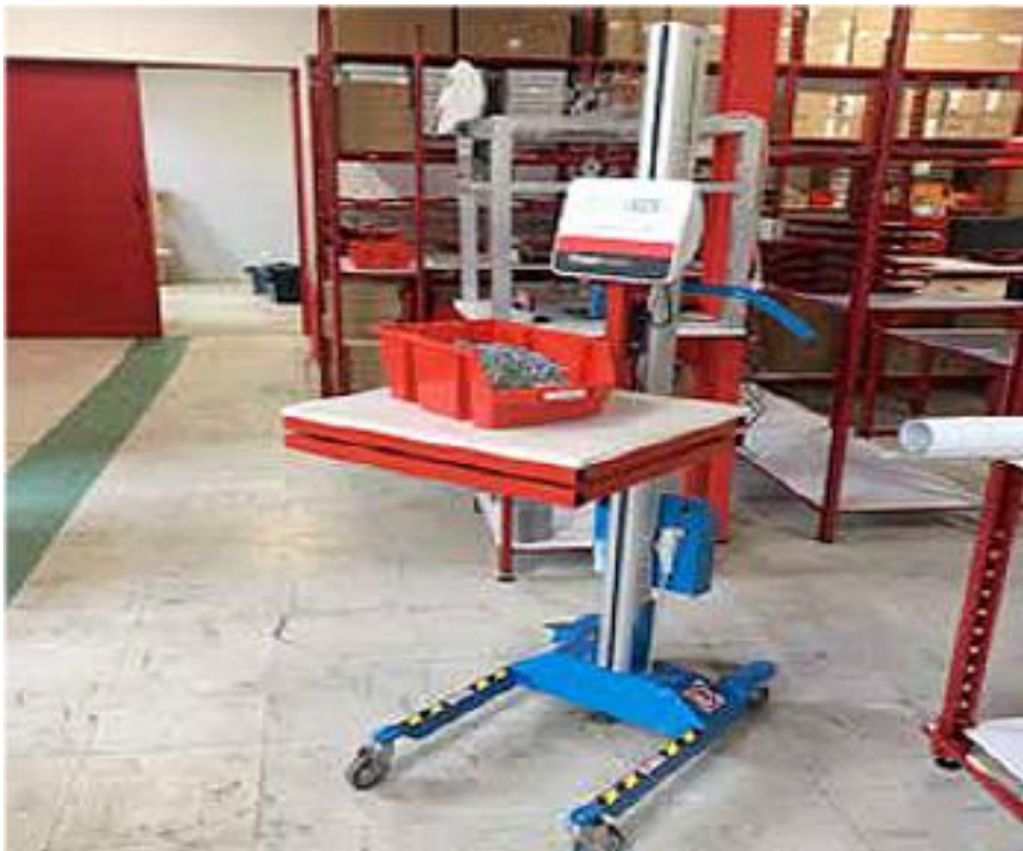
Le gerbeur et la table élévatrice dotés du système de pesage Rubis. ©Timber
